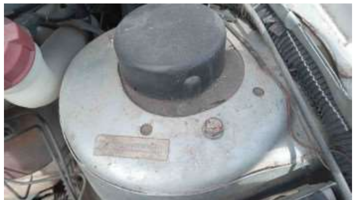
Foto Estrutura Torre do Amortecedor Esquerdo
