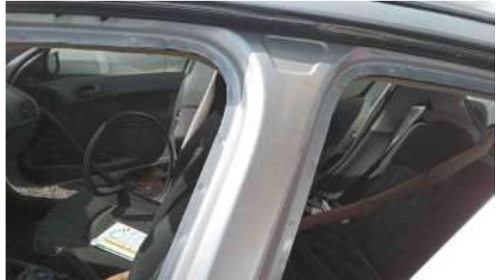
Foto Estrutura Coluna Central Esquerda
