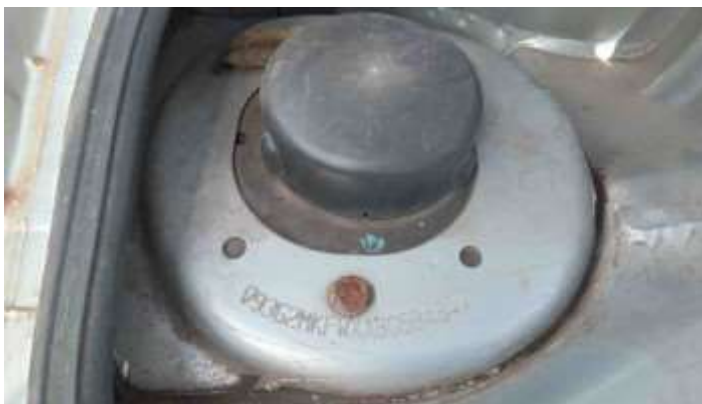
Foto Estrutura Torre do Amortecedor Direito
