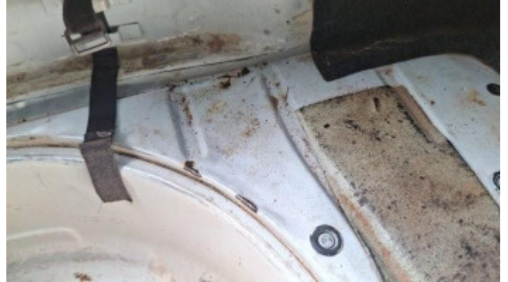
Foto Avaria Assoalho do Porta Malas
