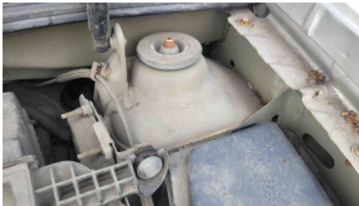
Foto Estrutura Torre do Amortecedor Esquerdo
