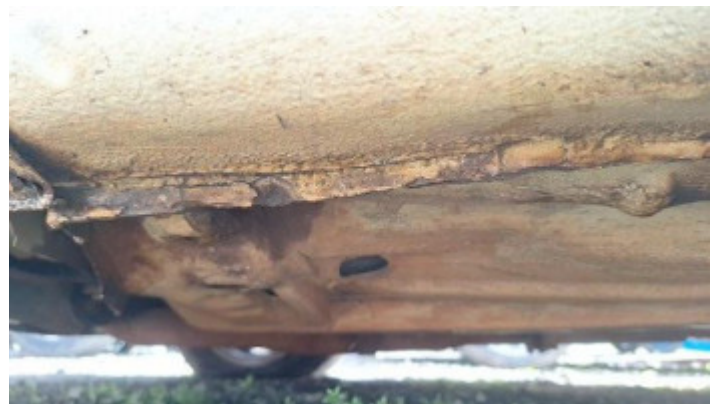
Foto Avaria Caixa de Ar
