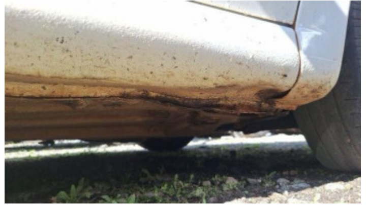
Foto Avaria Caixa de Ar
