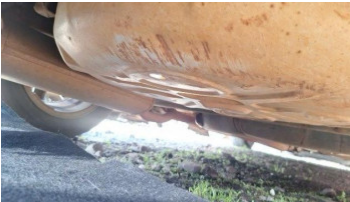
Foto Avaria Caixa de Estepe
