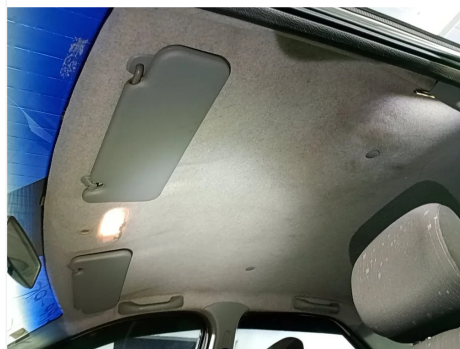
Forro de teto interno
