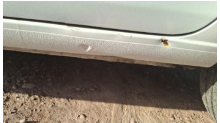
Foto Avaria Caixa de Ar
