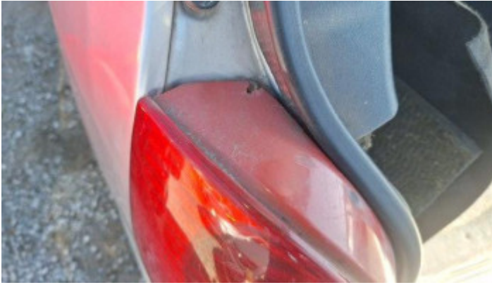
Foto Avaria Lanterna Esquerda
