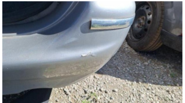
Foto Avaria Pára-Choque Traseiro
