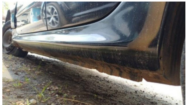
Foto Avaria Caixa de Ar
