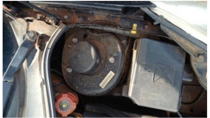
Foto Estrutura Torre do Amortecedor Esquerdo
