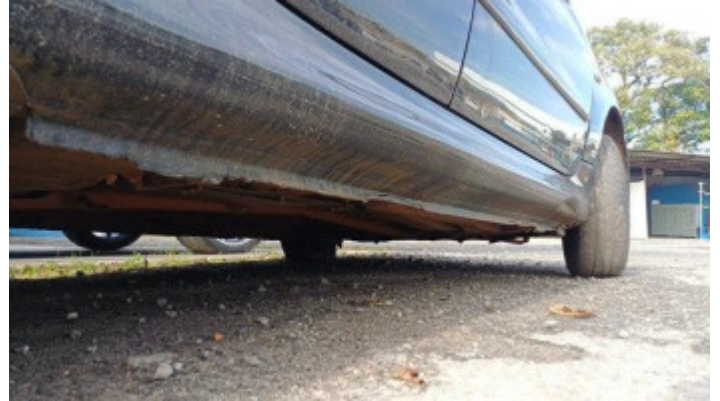
Foto Avaria Caixa de Ar
