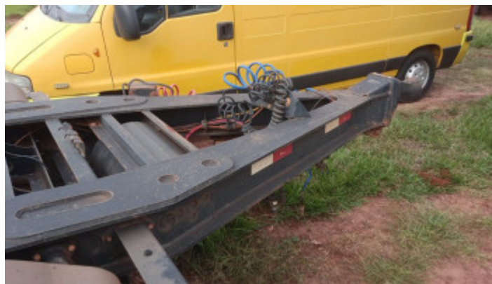
Foto Estrutura Longarina Direita
