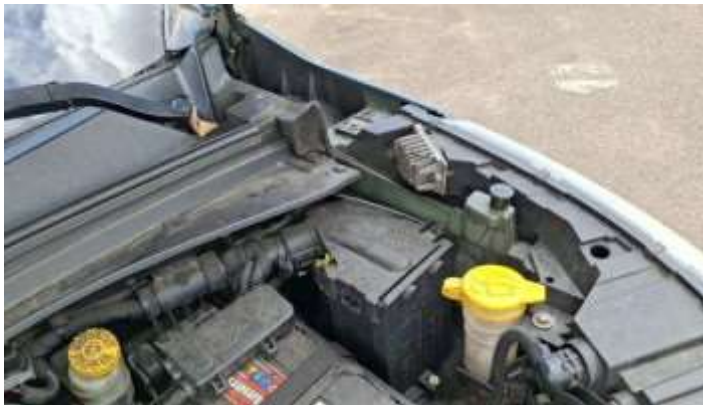
Foto Estrutura Torre do Amortecedor Esquerdo
