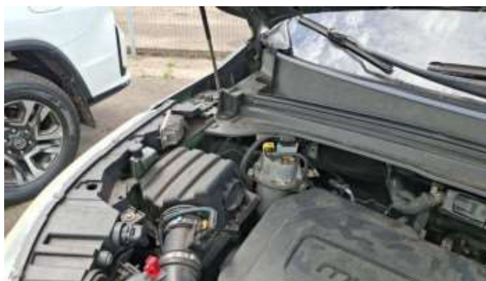
Foto Estrutura Torre do Amortecedor Direito
